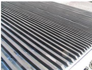
Die eingebrachten Gummistreifen haben eine Breite von etwa 5 mm und ragen ca. 6 mm aus den Füllstäben hervor. Sie bilden die Kontaktfläche und damit den wichtigsten Teil für den Anwender. Wobei es nicht nur ihre automatisch reinigende Wirkung ist, sondern auch das äußerst angenehme Gefühl beim Begehen. Dabei die frappierende Rutschfestigkeit, verbunden mit der Sicherheit, dass man sich beim Fallen nicht verletzen kann und natürlich die hohe Trittschalldämmung.
